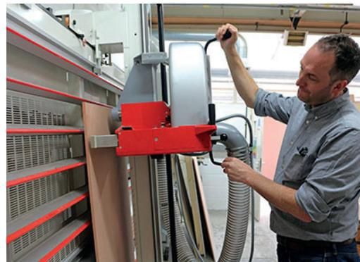
*Découpe sur une scie à panneaux dernière génération pour une rapidité et une précision de coupe avec lame carbure*
